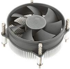
Рис. 12.3. Обертова частота кулерів сучасних процесорів становить 50–60 обертів за секунду
