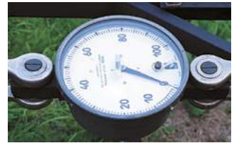
Рис. 24.6. Тяговий динамометр, призначений для вимірювання великих сил, наприклад сили тяги трактора
