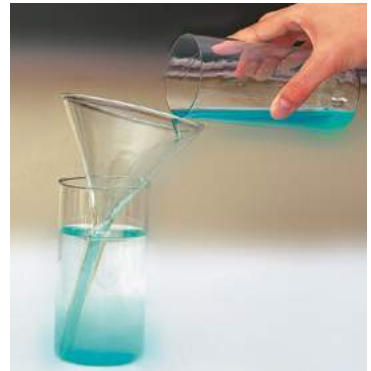
Рис. 5.1. За допомогою лійки можна акуратно налити розчин мідного купоросу на дно склянки з водою
