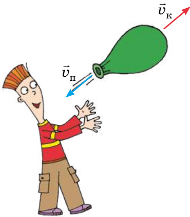
Рис. 21.1. Рух кульки під дією повітря, що виривається з отвору, — це реактивний рух
