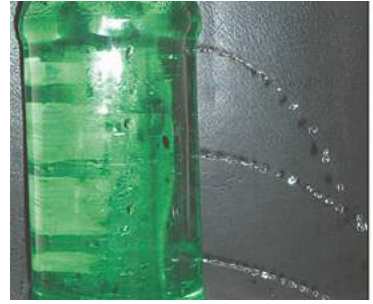
Рис. 29.4. Рідина створює тиск не тільки на дно, але й на бічні поверхні посудин
